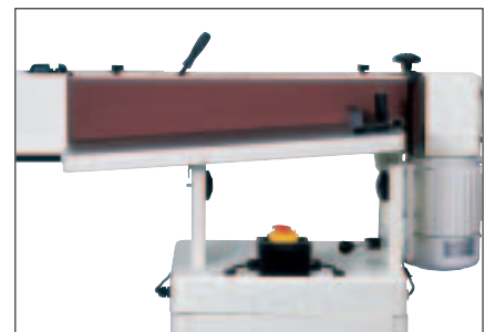
Tisch-Schrägstellung: Dadurch besseres Schleifbild und volle Ausnutzung des Schleifbandes möglich
